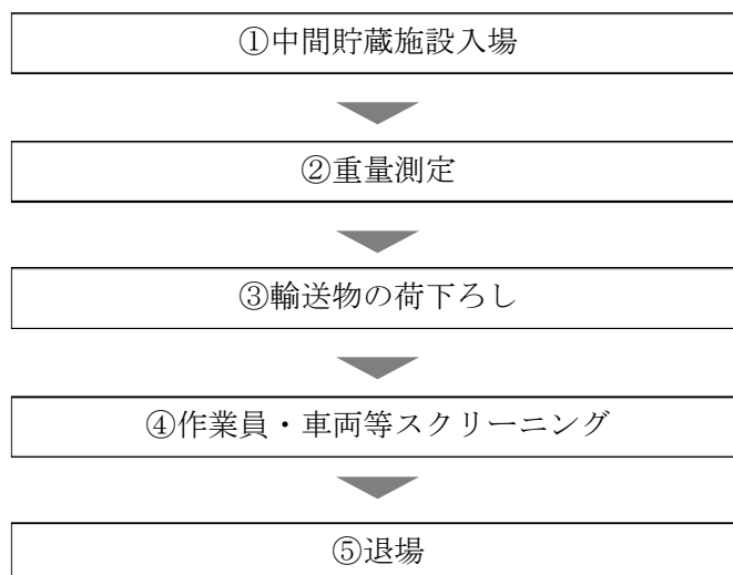
図 3-15 中間貯蔵施設における作業フロー
