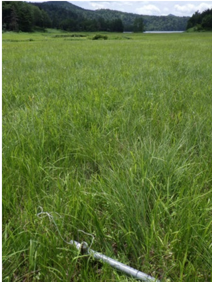
図8. 大江湿原の地下水位計パイプ (左図：湿原中央の木道付近)、(右図：三本カラマツ近傍)
