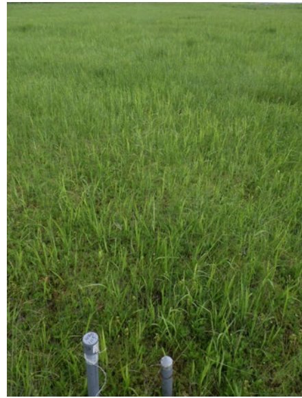
図8. 大江湿原の地下水位計パイプ (左図：湿原中央の木道付近)、(右図：三本カラマツ近傍)
