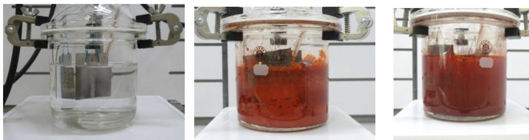
ステンレス鋼 (2か月後) 一般圧延鋼板 (2日後) 耐食性鋼板 (2日後)
