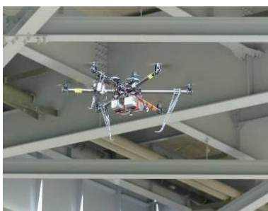
ドローンによる橋梁点検
