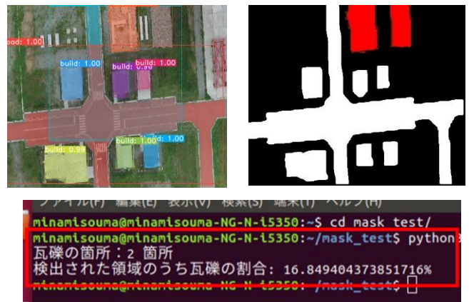
図7 人を検出した際の YOLACT の表示結果 オルソ画像の領域検出結果 (左上) マスク画像 (右上) 被害状況の分析結果 (下)
