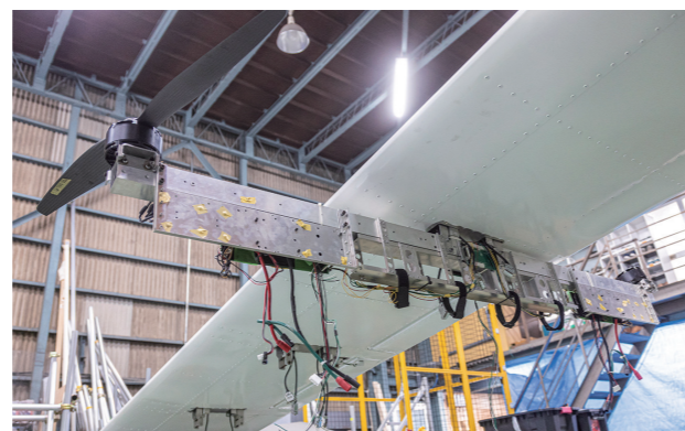
▲アリーナが手掛けたteTraMk-5の動力制御ユニット。
