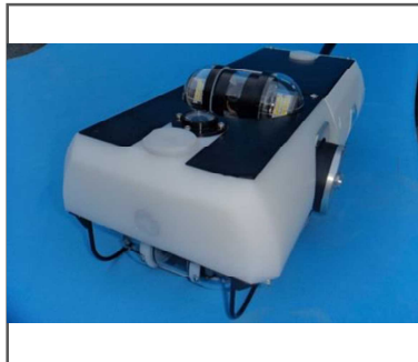
1号機調査装置 (ROV※ 3 -A2)
