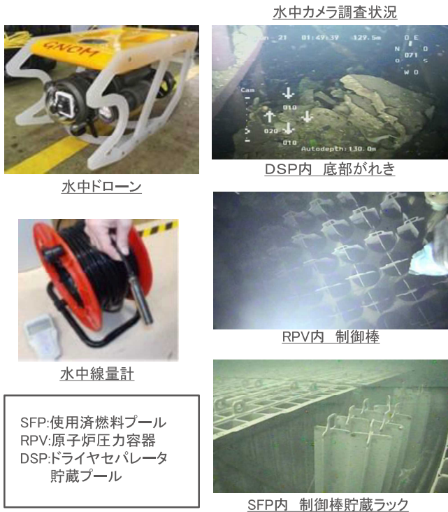
4号機 DSP,ウェル,SFP内の主な高線量機器
