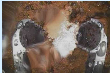
ペDESTAL内堆積物の把持状況
