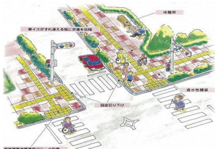
ユニバーサルデザインに配慮した歩道の整備イメージ
