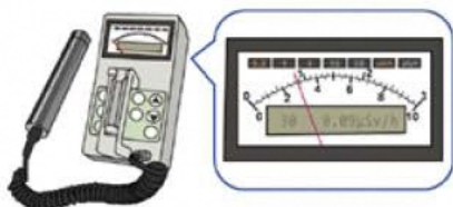
【図 2-10】線量の測定方法(NaI シンチレーション式サーベイメータ)
