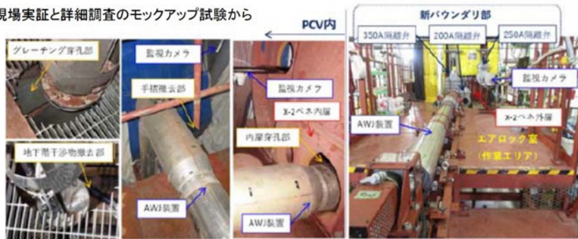
アクセスルート構築のモックアップ試験状況
