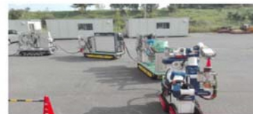
図2 上部階用除染装置
