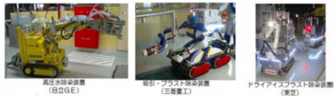
図2 平成24年度に製作した除染装置
