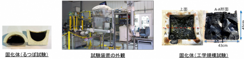
図3 インドラム式ガラス固化処理技術の試験装置及び固化体
