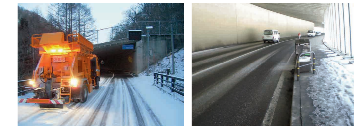
凍結抑制剤散布車の散布状況
