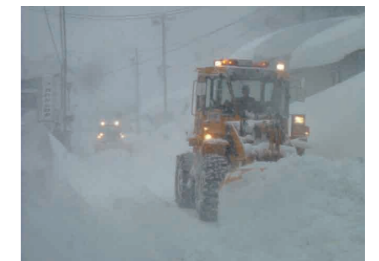
除雪ドーザによる新雪除雪の状況
