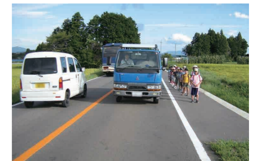
幅広路肩による歩行空間確保事例(本宮土湯温泉線)
