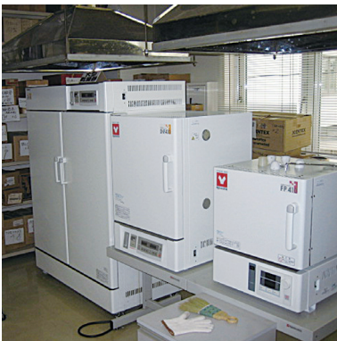
大型送風乾燥機 (写真左)
