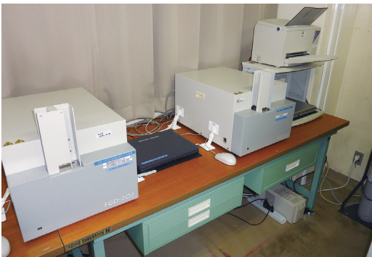
蛍光ガラス線量計読取装置
