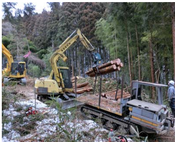
運材作業(フォワードャー)
